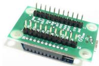
用途に応じて、基板の裏面にピンヘッダをハンダ付けすると他の回路と接続したり、ブレッドボードで実験することができます。XBee 用の黒い端子を溶かさなよう注意。
