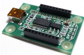
XBee 変換基板 (完成品)
