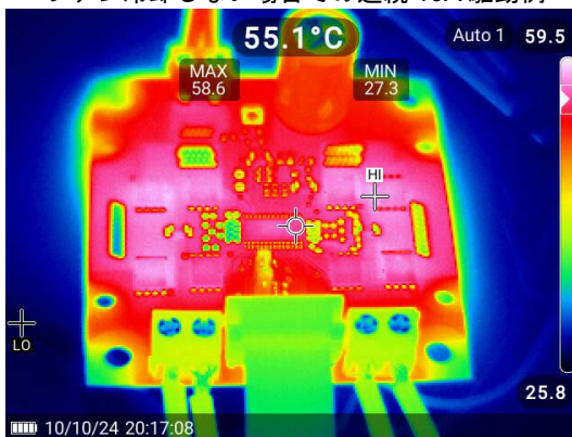
ファン冷却しない場合での連続 10A 駆動例
