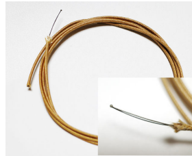
高耐熱シリカガラス被覆 K 型熱電対 0.32mm 径 約1m (片側溶接加工済み)
