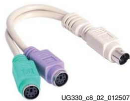
図 8-6 : PS/2 Y 字型スプリッタ ケーブル
