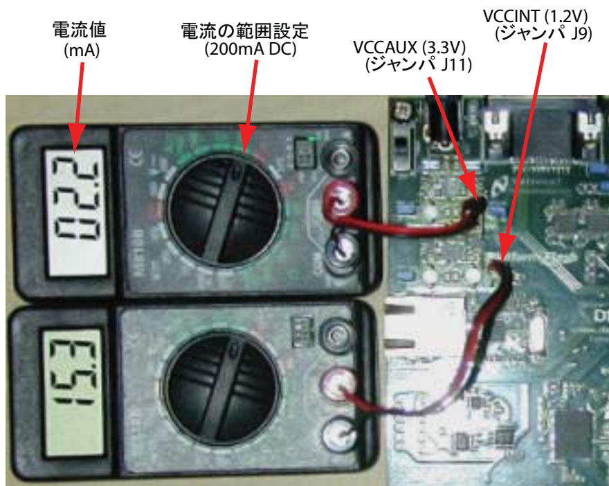
図 17-2：マルチメータを使用した電流 (電力) の測定
