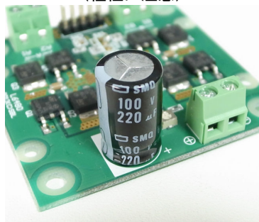
電解コンデンサ・電源部分 (極性に注意)
