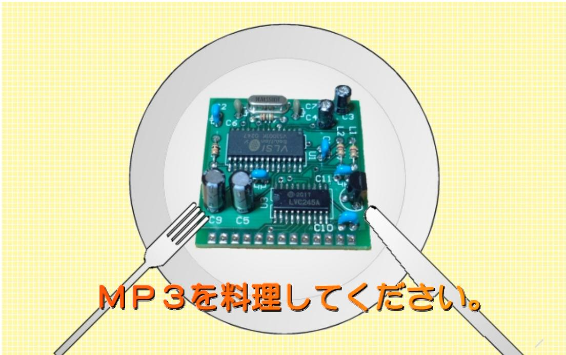
ファイルサイズが1/10になってもCD並のクオリティで音楽を再生することができる“MP3”、パソコンに限らず、携帯型プレーヤ・カーオーディオでも再生が可能な時代になりました。MP3の再生には高度なデジタル信号処理が必要です。パソコンのCPUでは簡単なことですが、小型・携帯型の製品では消費電力・演算スピードの面で困難です。そこでMP3再生専用のDSP（Digital Signal Processor）が製品化されています。
