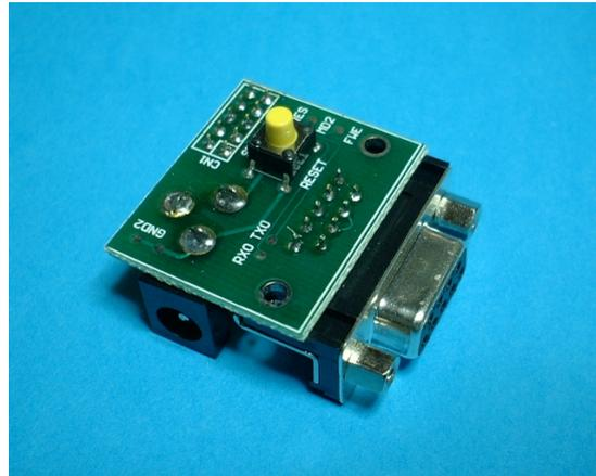
タクトスイッチ(プッシュスイッチ)はリセットスイッチです。押すとCPU・コンパクトフラッシュカードがリセットされます。
